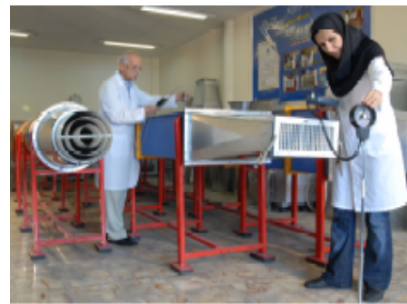
شکل (۴): تعیین فشار و سرعت برای دریچه دیواری
